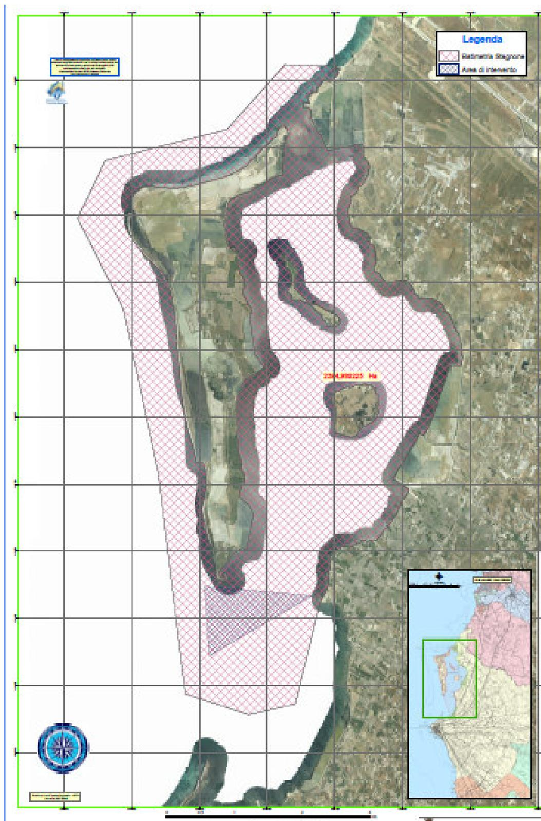
La **batimetria** è una disciplina della oceanografia e della geodesia che si occupa della misura delle profondità e della rappresentazione cartografica dei fondali. I rilievi batimetrici vengono effettuati quindi per la conoscenza dell'andamento morfologico del fondale marino e lacustre. Sono necessari alla
