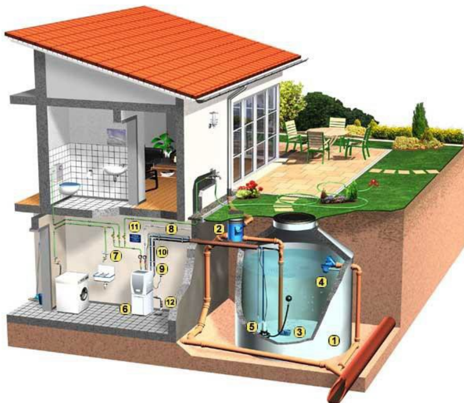
Figura 10 - Esempio di recupero delle acque meteoriche dei tetti per usi interni all'abitazione, tramite l'utilizzo di un filtro
