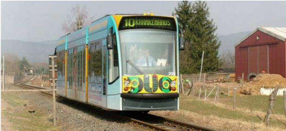
Figura 3.2 – A Nordhausen (GER) il servizio è stato realizzato unendo la linea tramviario urbana alla linea rurale HSB (Harzer Schmalspurbahn). In città la marcia avviene con trazione elettrica a 600Vcc, in campagna il veicolo è alimentato da un motore diesel situato a bordo.
