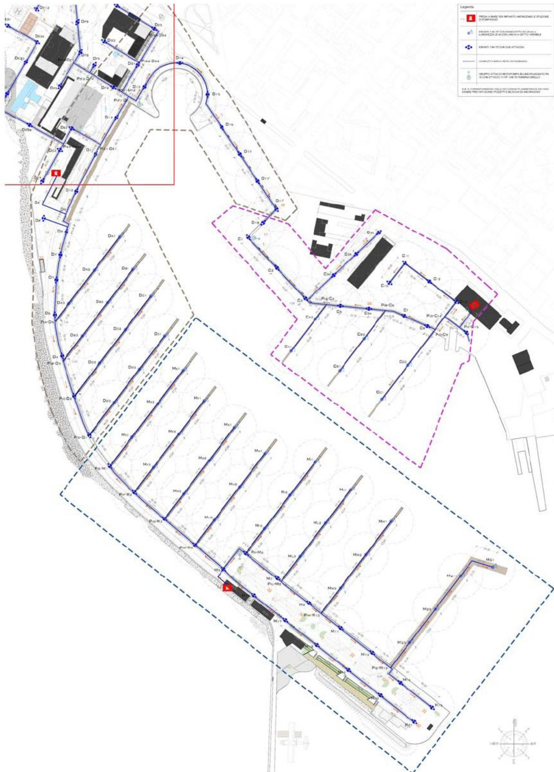
Impianto antincendio – Schema generale
